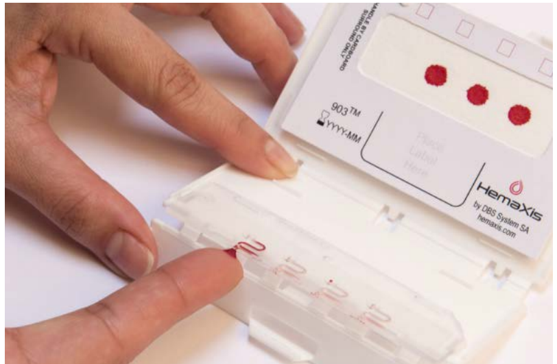
HemaXis DB 10 zur einfachen und genauen Entnahme und Bereitstellung von 10 µL Vollblut auf Dried-Blood-Spot (DBS) Karten zur Bestimmung unter anderem von PEth. Foto: DBS System
