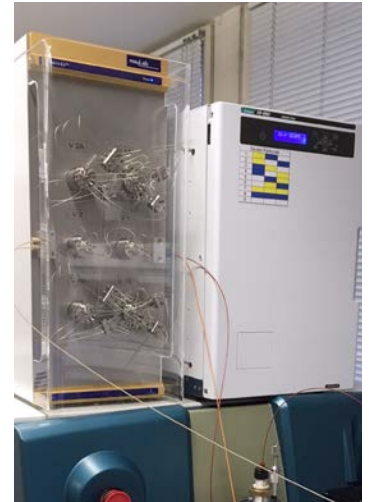
Effiziente LC/MS-Routineanalytik: „MayLab MatrixEX NG“ (New Generation) installiert auf einem Massenspektrometer.
